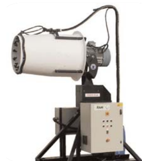
Des "turbo ram" projettent une fine vapeur d'eau pour limiter la diffusion de la poussière
